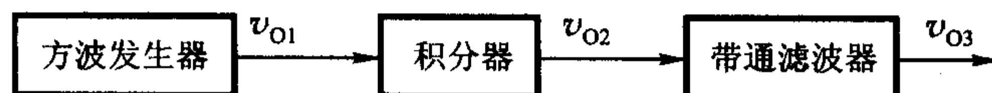
图 11.2.5 方波、三角波和正弦波信号发生器的方框图
