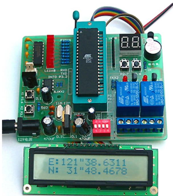
这是用 1602 液晶模块做的 GPS 卫星定位系统的显示屏，可以显示经纬度和时间。
