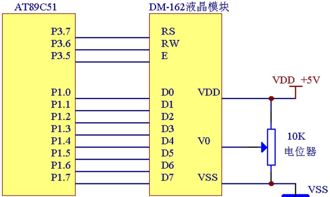
液晶显示模块是一个慢显示器件，所以在执行每条指令之前一定要确认模块的忙标志为低电平，表示不忙，否则此指令失效。要显示字符时要先输入显示字符地址，也就是告诉模块在哪里显示字符，表 3 是 DM-162 的内部显示地址。
