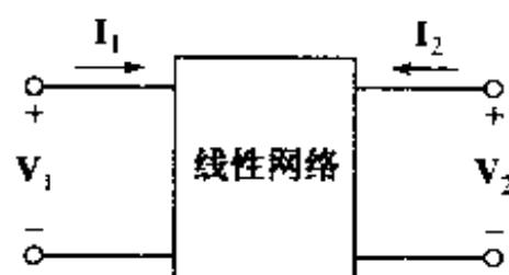
图 17.5 双端口电路模型，图中已经标出了端口电压和电流。该双端口电路由线性元件组成，还可能含有受控源，但不含任何独立源
