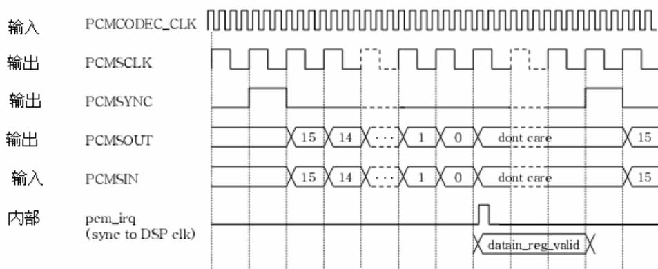
图 37-2 PCM 的时序, POS\_MSB\_WR/RD = 1
