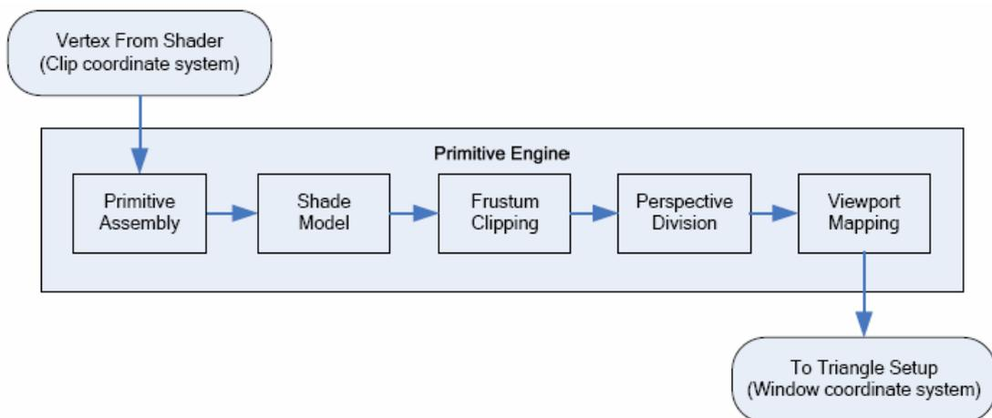
图 42-9 图元引擎的概念功能级模块图
