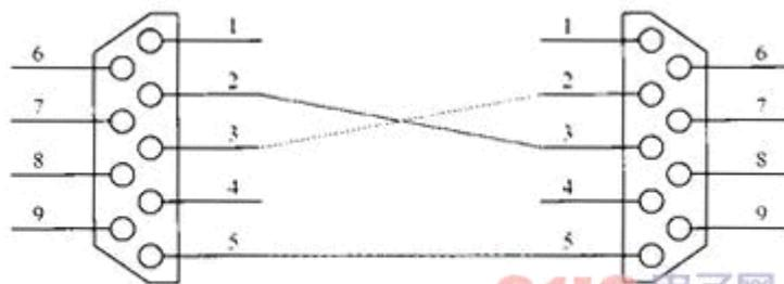
图2 上位机与单片机之间串口连接图
