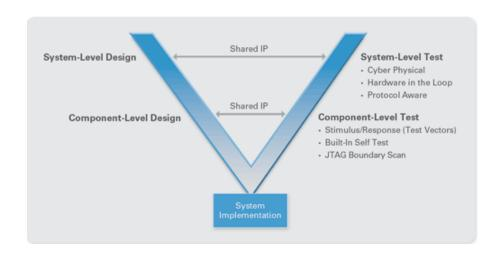
图1: 当设计大型的"由系统组成的系统"时,从 V 型图中可以很方便地看出:哪些子系统可以独立于整个系统进行测试。
