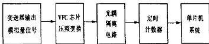
图 3 VFC 方式传送信号
