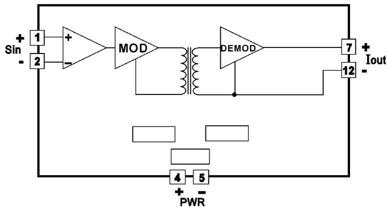
(2) 电压输出型产品引脚描述：单列直插 12 脚（SIP 12）封装
