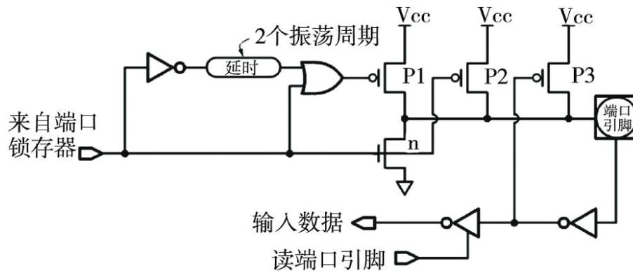
图2 准双向口 P1 内部结构
