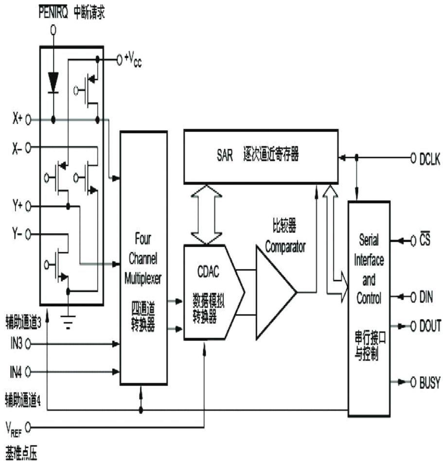
图3 AD7843内部原理结构
