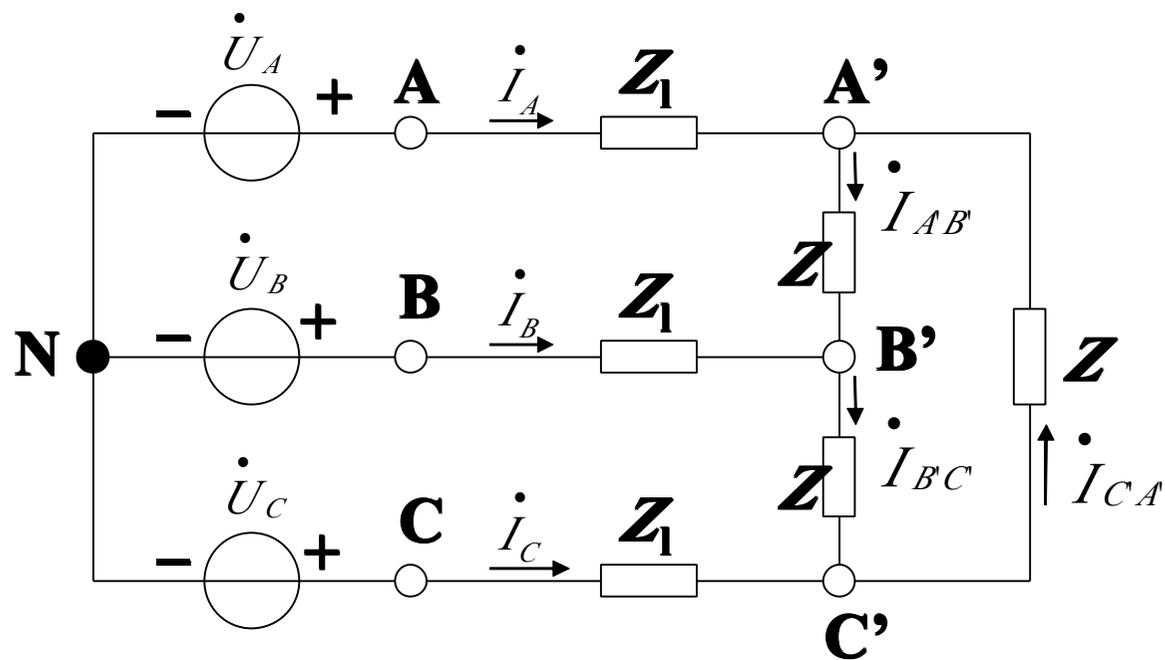
$$\dot{I}_A = \dot{I}_{A'B'} - \dot{I}_{C'A'} = (1 - \alpha^2) \dot{I}_{A'B'} = \sqrt{3} \dot{I}_{A'B'} \underline{-30^\circ}$$
