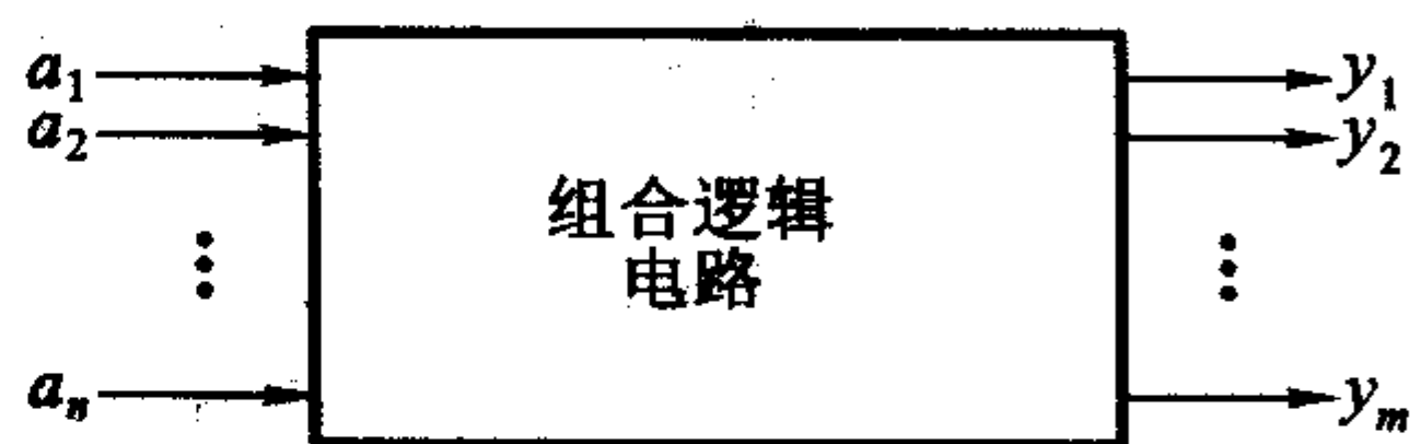
图 4.1.2 组合逻辑电路的框图
