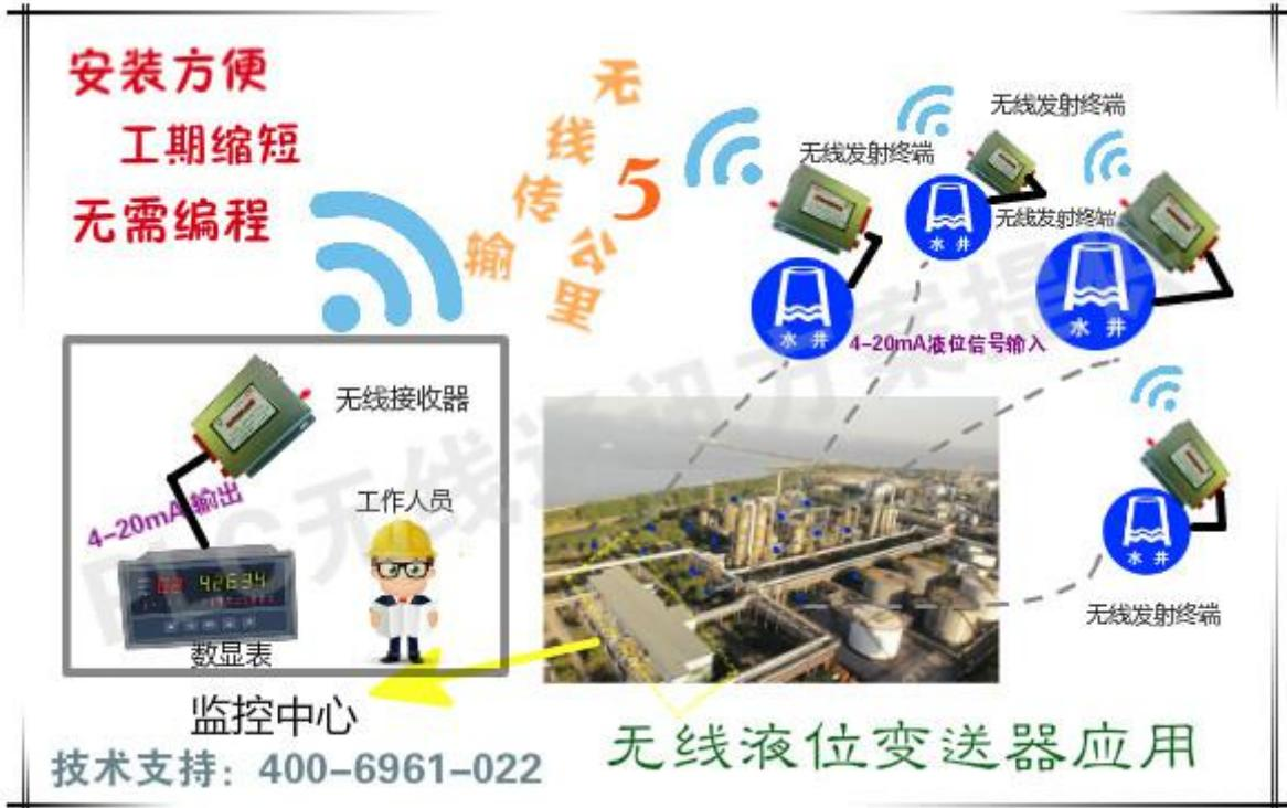
无线液位变送器的工作原理就是将现场液位变送器输出的标准 4~20mA 电流信号，通过无线信号发射器 **DTD110F-T** 传送给 5 公里外的监控中心。监控中心的无线信号接收器 **DTD110F-R** 同时输出 4~20mA 电流信号，连接数显表，使工作人员能够在远端监控 15 口水井的数据信息。
