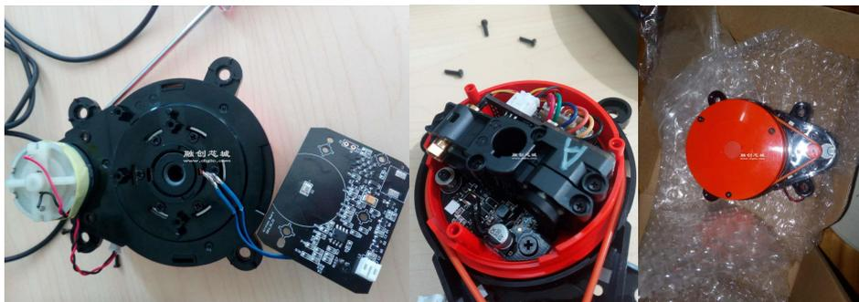
图 1-1 低成本激光导航传感器平均宽度是 8cm. 圆形载体, 有激光模块, 以及镜头
